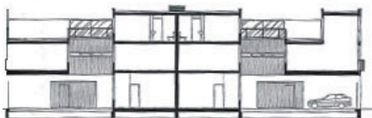
Longitudinal section of houses at Sporenburg 14 スボーレンブルグ14区の住戸の長手断面図
